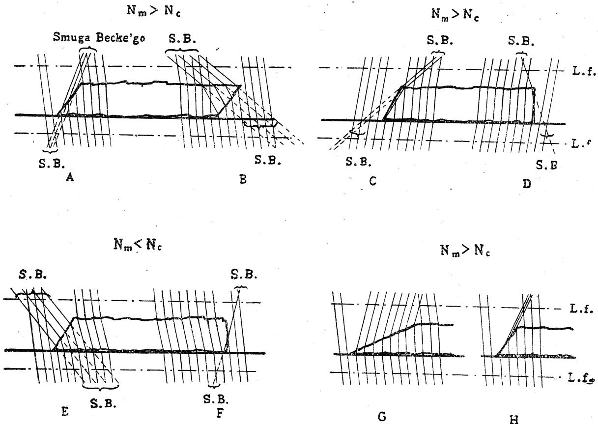
Rys. 1. Przebieg promieni świetlnych w odłupkach minerału i w cieczy, przy różnych wzajemnych stosunkach współczynników zał. św.; L. f. = linia fokusowania; S. B. = smuga Becke'go;  $N_m$  = współczynnik zał. św. minerału;  $N_c$  = współczynnik zał. św. w cieczy
